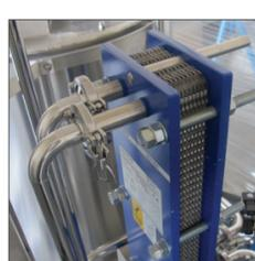
Le moût doit être refroidi à la température de fermentation, suivi par l'addition de la levure. Le processus de refroidissement du moût est effectué à l'aide d'un échangeur de chaleur à plaques.
