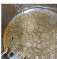
Lorsque l'ébullition est terminée, les particules solides doivent être séparées du liquide. Quand il est activé, le whirlpool fait rassembler les particules solides au centre du fond de la cuve, de sorte qu'elle puissent être facilement enlevées.
